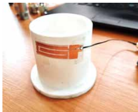
Рис. 8. Фото антени на циліндричному тефлоновому стакані
